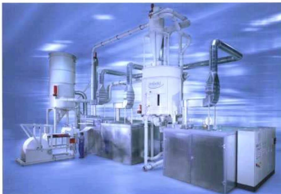
Installation pour le broyage fin de cellulose avec trois machines SMF 500/1000
