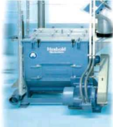
Laveur intensif avec nettoyage mécanique et décolmatage de la grille par jet d'eau
