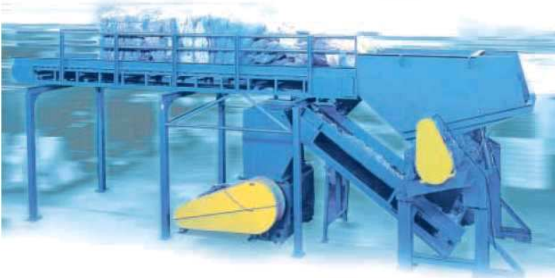
Broyeur équipé d'un convoyeur d'alimentation et d'un convoyeur tampon
