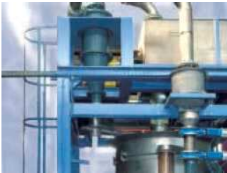
Vue partielle d'un cyclone à particules lourdes et d'un hydrocyclone
