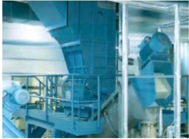
Broyeur humide avec plate-forme d'entretien. L'alimentation a lieu par l'étage en dessus. Le produit broyé et lavé tombe dans un laveur à frictions.
