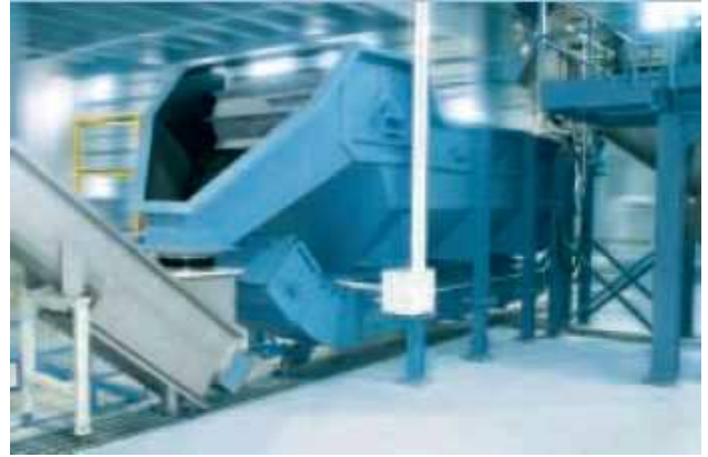
Bac de flottation avec convoyeur à raclettes
