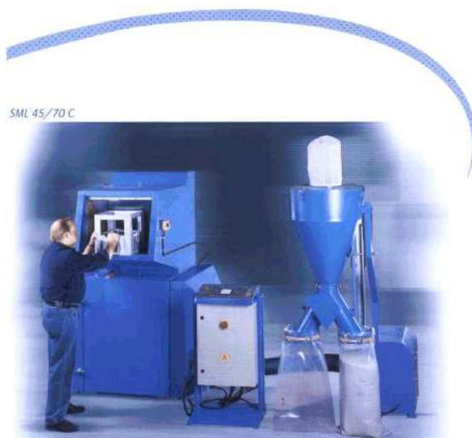
SML 35/42 avec insonorisation intégrée, tirage par rouleaux et trémie
