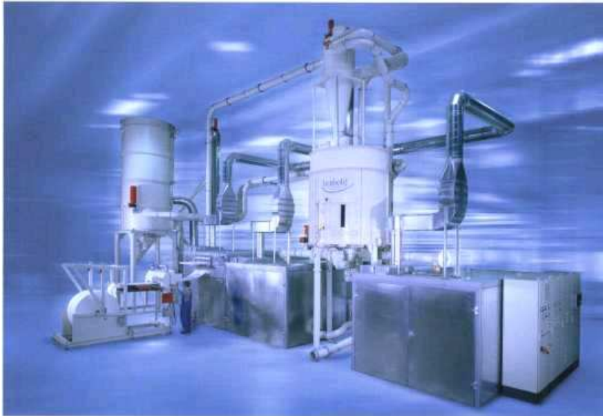
Installation intégrale pour la micronisation de cellulose, équipée d'un système antiexplosion
