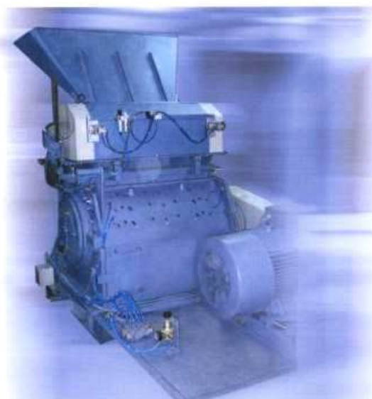
Machine avec dispositif de tirage pour produits alimentés en continu et sur rouleaux rolls
