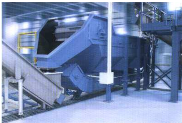
Bassin de tri par flottation
