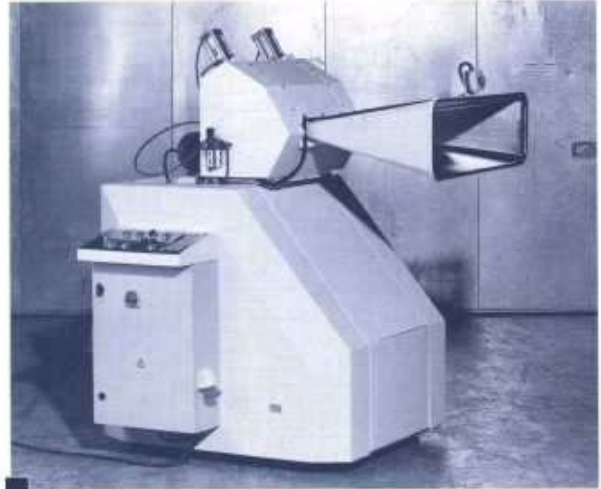
装有防噪声，喂料搅轮和收集漏斗的 SML 35/42C
